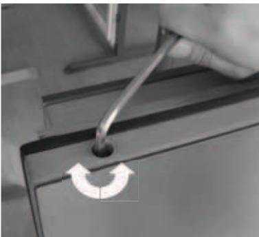
2. Mit einem 6mm Inbusschlüssel die Spannstange verstellen. Durch drehen im Uhrzeigersinn wird die Stange gespannt und die Flügelenden nach innen gebogen, durch drehen gegen den Uhrzeigersinn wird die Stange gestreckt und die Flügelenden nach außen gebogen.
