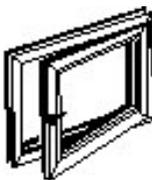
Lassen Sie den Fenstergriff in Kippstellung und drücken Sie den Flügel auf der Scherenseite an den Rahmen und drehen Sie den Griff (90°) in die Drehstellung.
