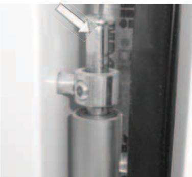
Beim Einsetzen der Bandbolzen auf die richtige Ausrichtung achten, die abgeflachte Stelle muss sich im Bereich der Wurmschraube befinden.
