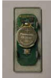
Batterie aus dem Bedienteil herausnehmen und neue einsetzen und Cover wieder aufsetzen und nach unten schieben.
