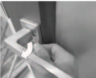
2. Spezialwerkzeug um ca. 90° drehen, Spannsystem wird gelöst.
